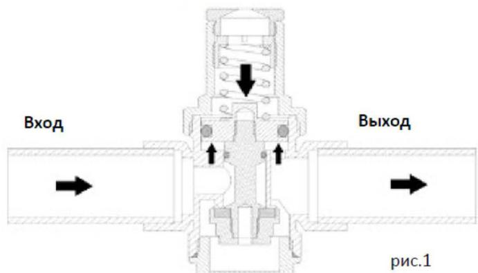
При открытии крана, вентиль (1) перемещается вниз открывая проход воде. Это происходит из-за силы давления пружины на диафрагму (2) которая в данных условиях становится превалирующей в сравнении с силой воды. При увеличении расхода воды, увеличивается проток воды внутри редуктора из-за уменьшения давления которому обычно подвергнут вентиль (1). При открытии нескольких кранов происходит падение давления ( $\Delta p$ ) на выходе, и последующее увеличение расхода (Q) как показано на графике № 2.
