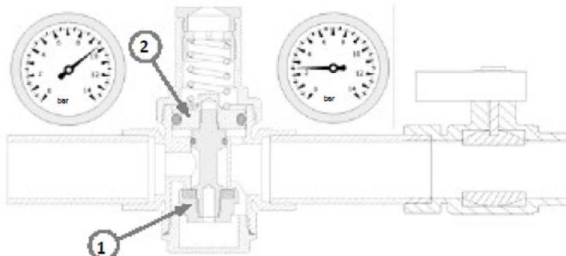
При закрытых кранах, давление на выходе увеличивается до достижения установленного значения в фазе настройки.
