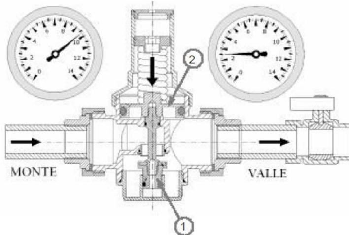
При закрытых кранах, давление на выходе увеличивается до достижения установленного значения в фазе настройки.
